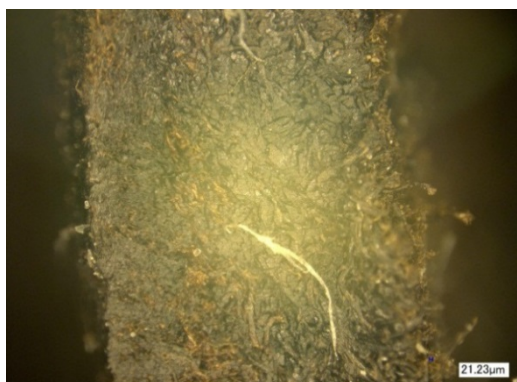
Рис. 2 – Поперечный срез кожной ткани кожной ткани археологического объекта, обработанного ННТП в гидрофильном режиме, после процесса консервации (x100)
