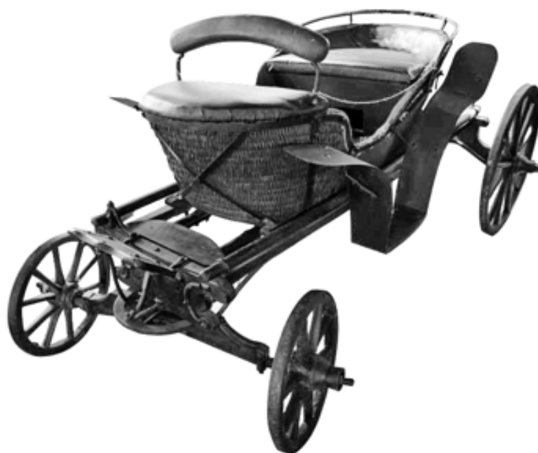
Рисунок 13 – Тарантас на железных рессорах с плетеным кузовом Figure 13 – Tarantas cart with a wicker body and iron springs
