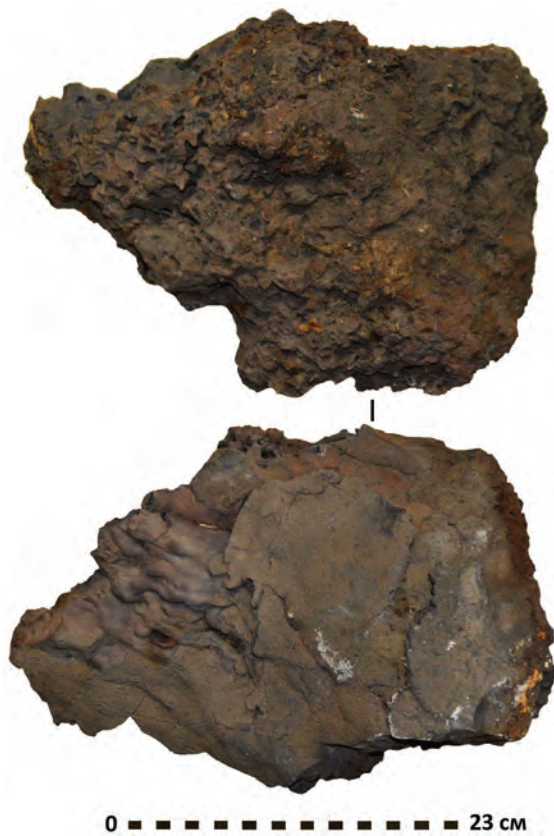
Рис. 9. Железный конгломерат из металлургического горна у с. Архангельское.
