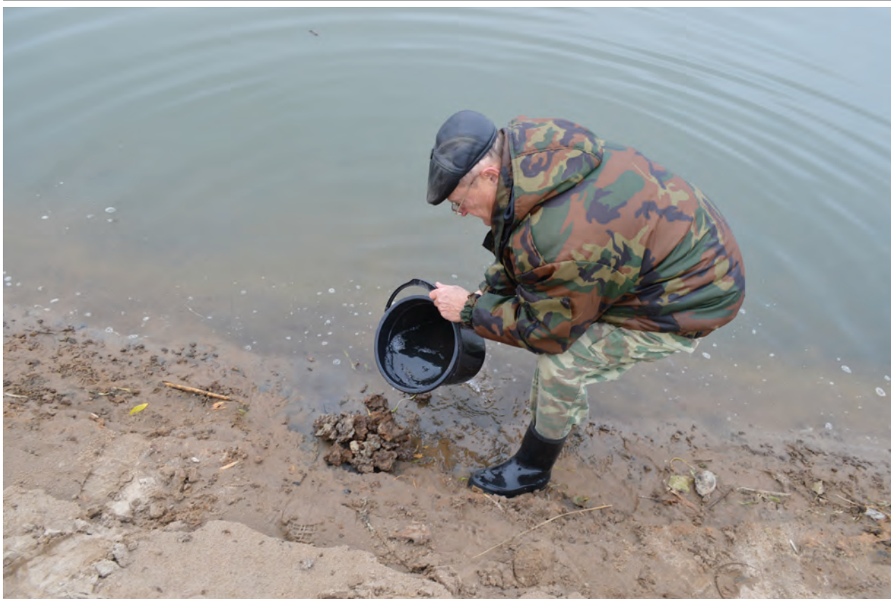
Рис. 5. Промывка луговой (болотной) руды в урочище «Орлово болото».
