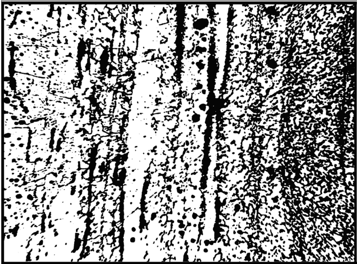
Нож 21. Пакетный металл. Полосы феррито-перлита и феррита. Шлаковые поля и неметаллические включения. X 125.
