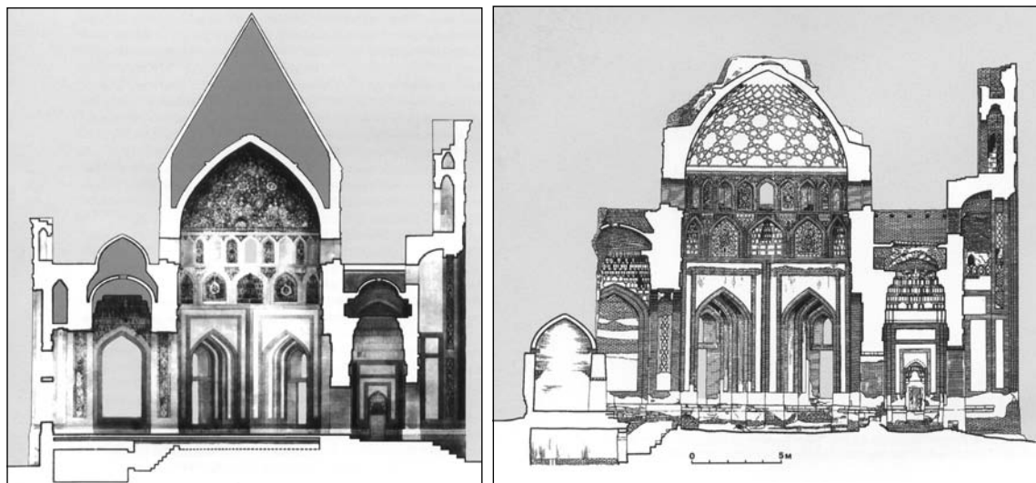
Куны-Ургенч. Мавзолей Тюрабек-ханым. Слева: разрез по обмерам А.Н.Виноградова, справа: реконструкция М.М.Туктарова
