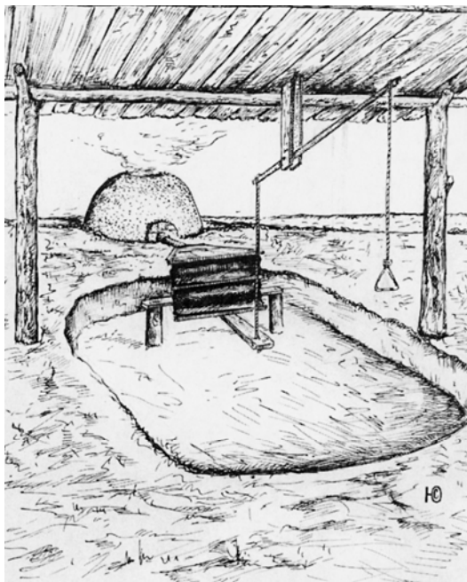
Графическая реконструкция металлургического горна наземной конструкции Волжской Булгарии домонгольского периода
