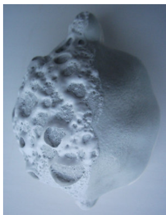
Рисунок 3 – Образец с декоративным покрытием после политого обжига при 1210 °С с глазурью матовой белой (слева) и прозрачной глянцевой (справа).
