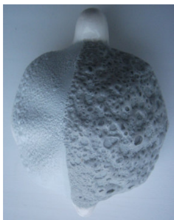
Рисунок 2 – Образец с декоративным покрытием после политого обжига при 1210 °С с глазурью матовой полупрозрачной (слева) и прозрачной с ZnO (справа).
