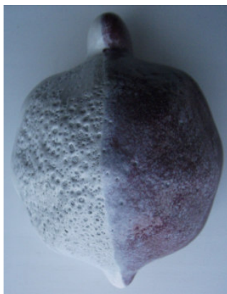
Рисунок 1 – Образец с декоративным покрытием после политого обжига при 1210 °С с глазурью глухой белой (слева) и окрашенной пигментами (справа).
